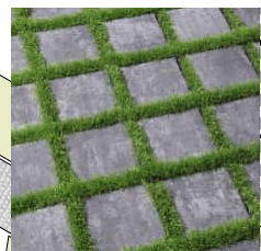
skládaná zatravnovací betonová dlažba velikost: 200 x 200 mm včetně 30 mm spáry výška dlažby 80 mm vjezdy + parkovací místa
